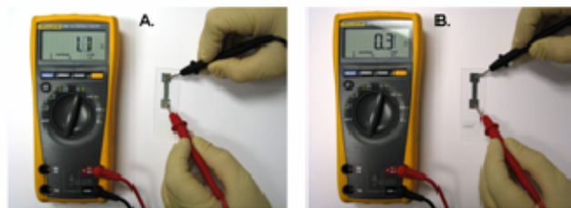
Figure 8. Resistance values. A. ANP silverjet nanopaste. B. Cabot Inkjet Silver Conductor.
