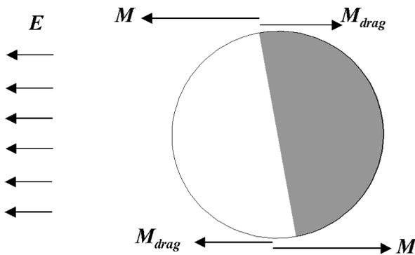
Figure 11. Moment pairs on unit disc.
