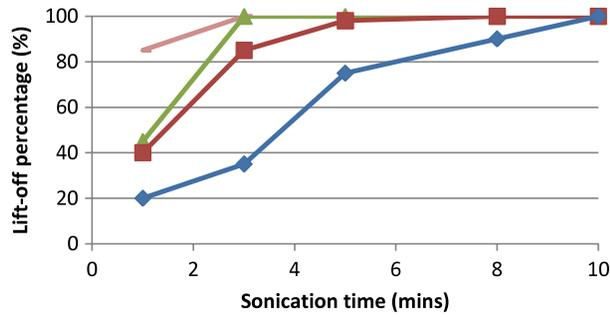
Resin height: — 15  $\mu\text{m}$  — 11  $\mu\text{m}$  — 7  $\mu\text{m}$  — 3  $\mu\text{m}$
