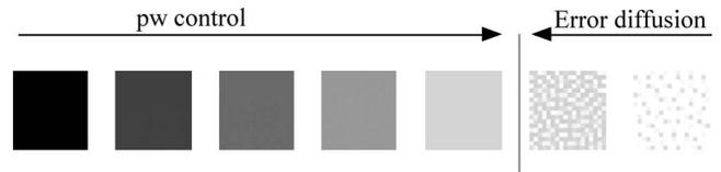
Figure 3. Highlight error diffusion method.
