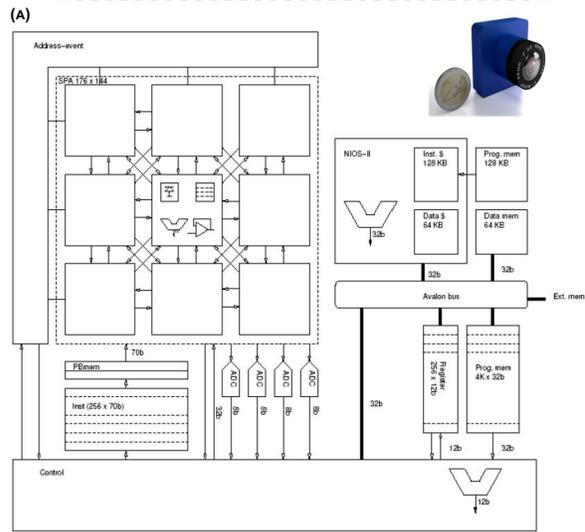
FIGURE 6 EYE-RIS VIVION SYSTEM: (A) BLOCK DIAGRAM; (B) ARCHITECTURE [13].
